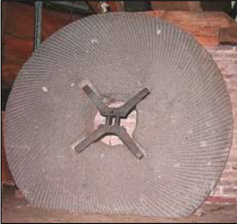
Unterseite des Läufersteins, die eiserne Haue ist dem Mühleisen oben aufgesetzt und überträgt das Drehmoment vom Mühleisen auf den Stein.
