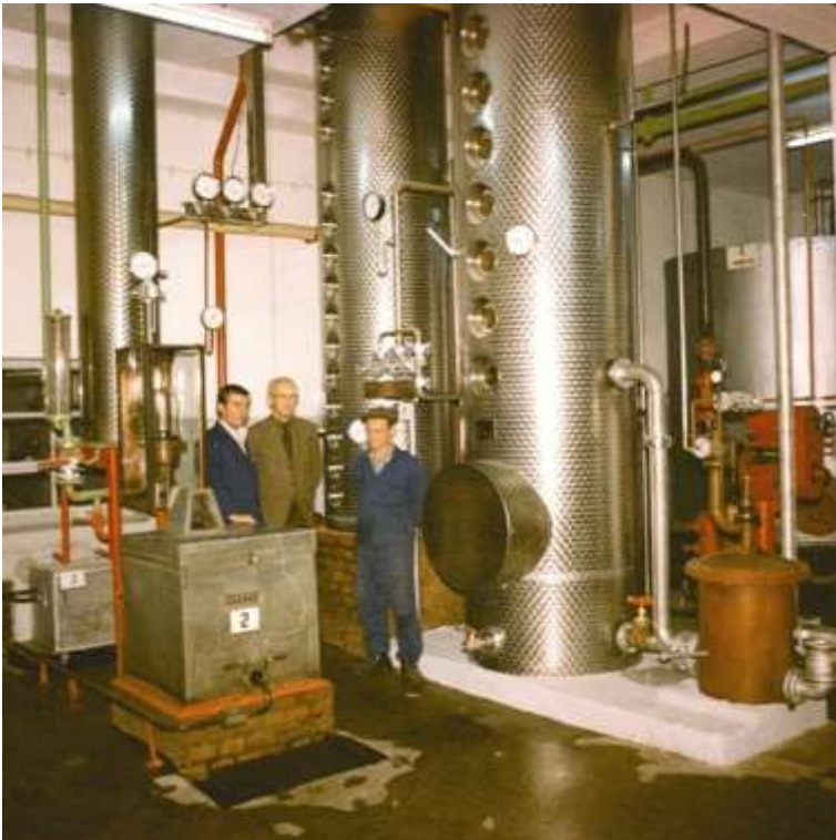
Der pensionierte Brennereileiter Kurt Stöber besucht die Brennerei. Ernst Baranyai und Kuni Hafner vor der neuen Fraktionierkolonne aus NIROSTA.
