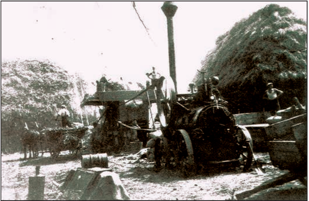
Oben: Antrieb einer Dreschmaschine durch eine Dampfmaschine. Vermutlich wurde das Bild im Gutsbetrieb aufgenommen, da die Strohristen sehr groß sind.
