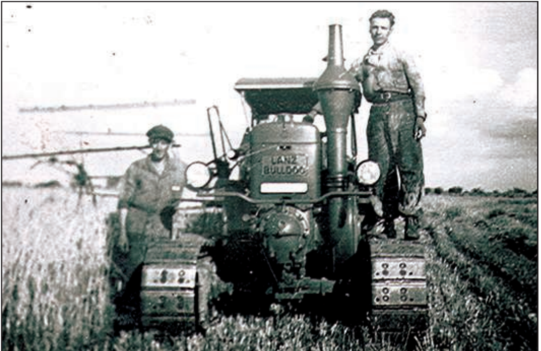
Unten: Im Gutsbetrieb schreitet die Mechanisierung voran. Lanz Bulldog mit Kettenfahrwerk und angehängtem Bindemäher.
