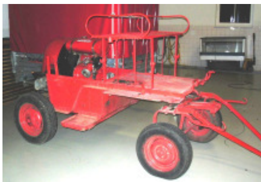
Zugwagen mit Motorspritze Gugg VW: Der ursprünglich von Pferden gezogene Wagen wurde von Herrn Eugen Hagara zum Traktoranhänger umgebaut.
